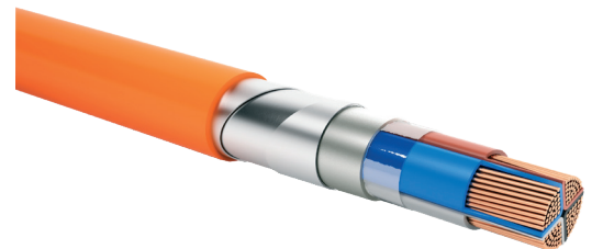
Кабель силовой с многопроволочными жилами секторной формы, в броне из оцинкованных лент, с оболочкой «ЗГ» - стойкой к грызунам, муравьям и термитам КУСИЛ нг(С)-HF 4x75мс(N) ПБ-ЗГ-1
