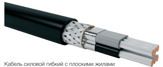
Кабель силовой гибкий с плоскими жилами КУСИЛ-Г нг(А)-HF 2x10мк(л) ПЭаЭл-П-УФ-0,66 – аналог кабеля TFL 492 325/0 прямоугольной формы
